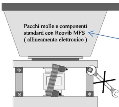
Pacchi molle e componenti standard con Reovib MFS (allineamento elettronico)
